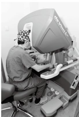
外科手术机器人一般由外科医生控制台、床旁机械臂系统、成像系统三个部分组成
